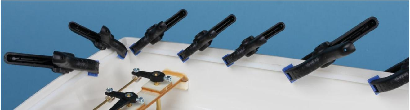
Lage der Hilfsscheuerleisten (3) mit umgebauter Vorrichtung 12 mm von der Decksoberkante markieren. Die gemäß Plan abgelängten 2 x 2 mm ABS-Profile wie beschrieben, verkleben. Die am Heck quer laufende Leiste 3 ebenfalls ankleben. Die Scheuerleisten selbst werden nach dem Lackieren des Rumpfes angebracht.
