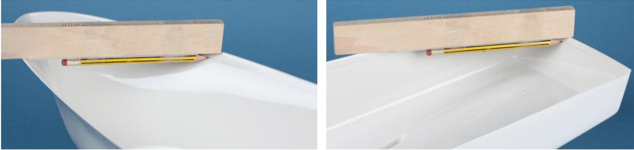
Im Bereich des Übergangs zwischen Hauptdeck und Vorderdeck ist die Markierung gemäß Plan mit Hilfe eines Lineals weiterzuführen. Die Decksauflageleisten werden später eingeklebt.
