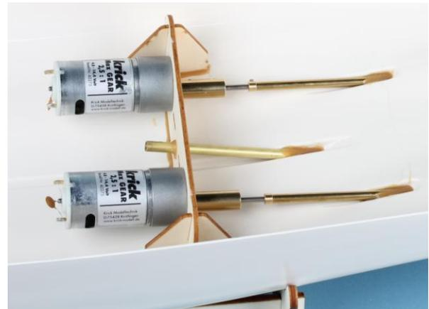
In die Stevenrohre Wellenfett GLS (bzw. einige Tropfen dickes Öl) einfüllen und die Schiffswellen einsetzen. Schiffsschrauben (20)  $\text{Ø } 50$ , 3-Blatt rechts und links (50 R und 50 L) mit M4 MS Kontermuttern montieren und die Wellen auf leichten Lauf prüfen. Vor dem Einbau sind die Motoren nach Plan mit den Filtern (21) zu entstören und mit etwa 150 mm langen Anschlusskabeln (22) zu versehen. Das Ansaugrohr vorsichtshalber wasserdicht verschließen.
