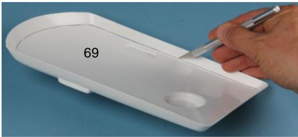
Zum Abschluss dieses Arbeitsschrittes die Blenden (68) aufkleben. Das Kabinendach (69) wird ausgeschnitten, sauber ausgerichtet und mit Acrylit an den Rändern der Kabinendecke verklebt. Damit ist der Rohbau des Modells beendet und.
