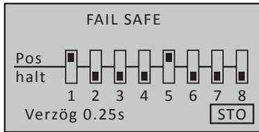
Wir empfehlen Kanal 1 und Kanal 5 entsprechend der Senderanleitung auf „Pos“ zu stellen und vor dem Speichern der Fail-Safe-Einstellungen den Gas-/Pitch-Steuerknüppel in die Motor-AUS-Position und den Lage-/Drehratenmodus-Umschalter in die Position „Lagemodus“ zu bringen damit dieser in Fail-Safe-Situationen aktiv ist:
