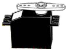
**15** Das Ruderhorn in Neutralstellung so auf das Servo schrauben.
