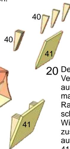
**20** Den Spiegel 39 und die Verstärkung 39.1 aufkleben. Den markierten unteren Rand mit 10 mm schräg schleifen. Je drei Winkel 40 zusammenkleben und auf die Motorhalterung 41 aufkleben.
