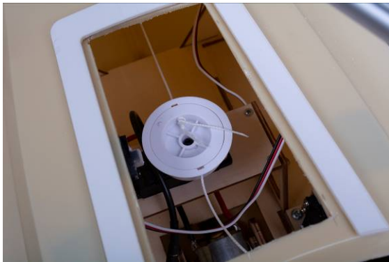
Abb. Segelwinde montiert
