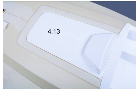
Abb. Schiebeluk einpassen
