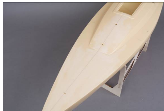
Vue perçages du pont
