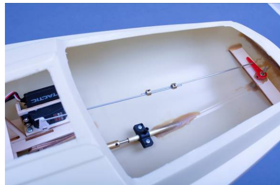
Abb. Verbindung Servo und Ruder
