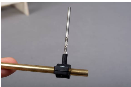
Abb. Schmierbohrung in Stevenrohr bohren
