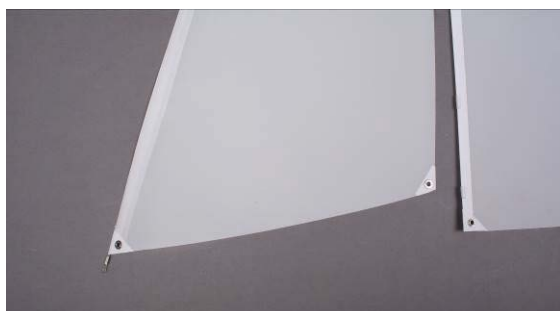
Vue: œillets sur voile avant
