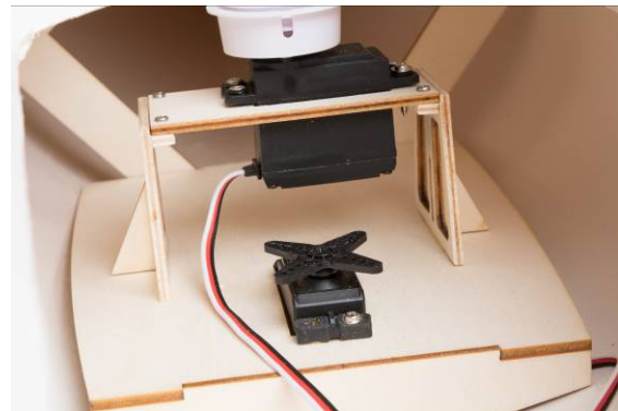
Abb. Windengestell auf dem RC-Brett
