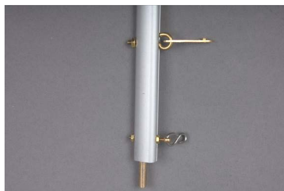
Abb. Befestigung Lümmelbeschlag und Niederholer
