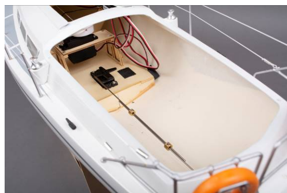
Fig. rudder linkage
