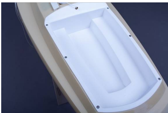
A Abb. Plichtbefestigung
