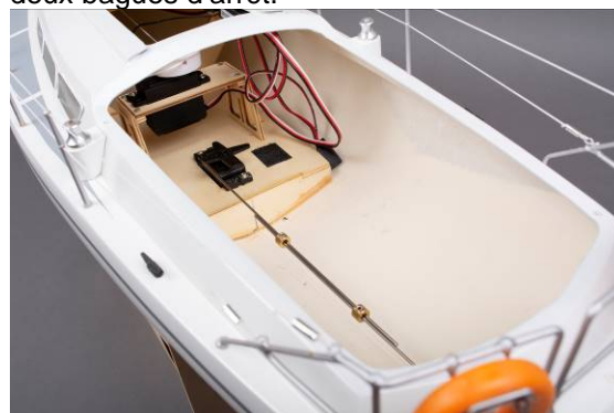
Vue: tringlerie de gouvernail
