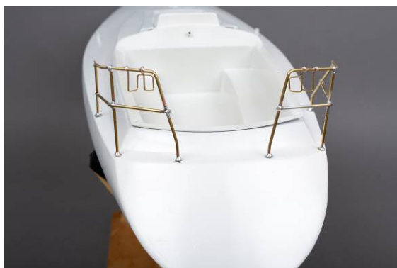
Vue: balcon arrière avec supports pour les bouées fer à cheval
