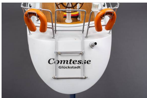
Abb. Badeleiter hochgeklappt, arretiert
