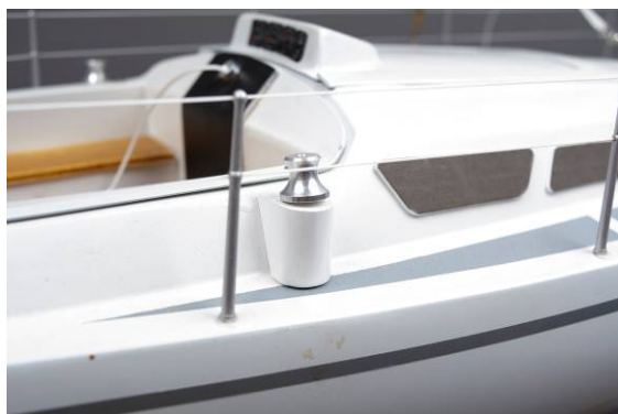
Vue: socle de winch et winch
