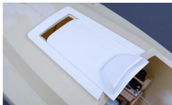
Vue: cadre collé et écoutille ajustée
