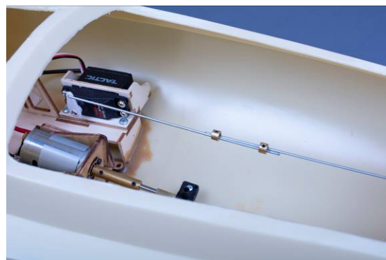
Vue: support servo avec servo
