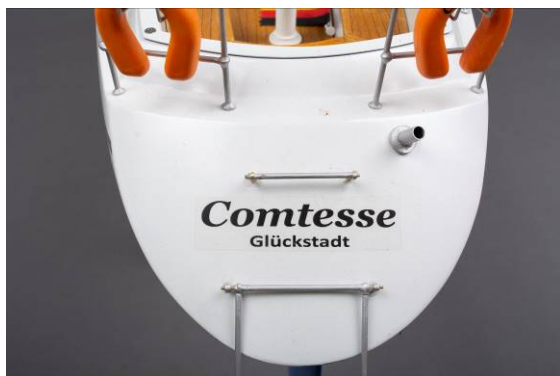
Abb. Badeleiter abgeklappt, Zusatzsprosse
