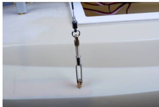
Vue: fixation des haubans
