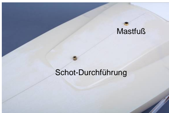
Abb. Schot-Durchführung Fockschot und Mastfuß
