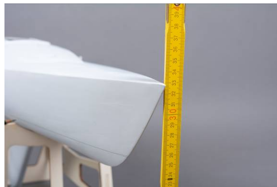
Abb. Bug ausrichten
