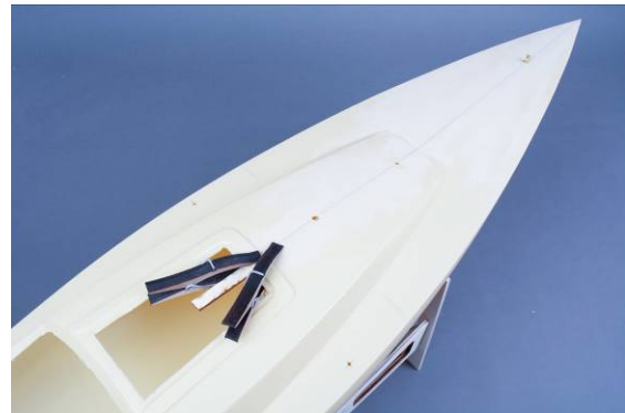
Abb. Verstärkungsblechen in Position
