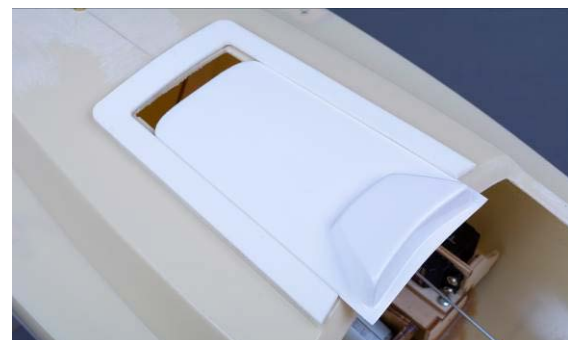
Abb. Rahmen verklebt, Schiebeluk einpassen
