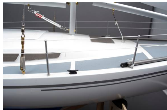
Abb. Klampe mittschiffs
