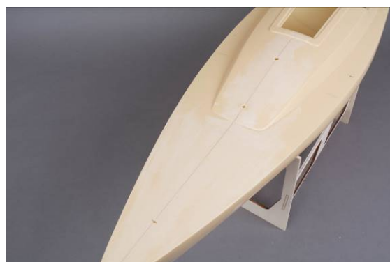
Abb. Bohrungen im Deck
