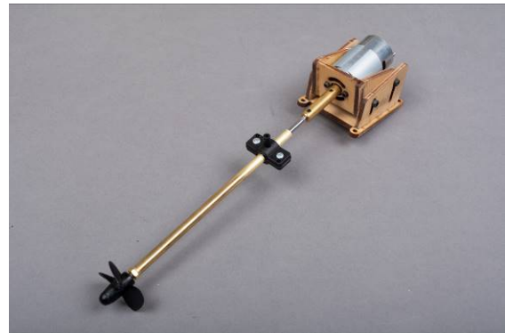
Abb. Montierter Antrieb
