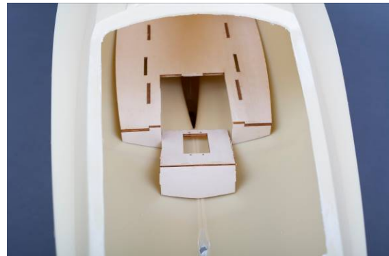
Abb. Austrennen für den Antrieb
