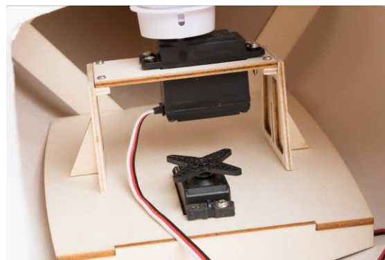
Vue: support de treuil sur platine RC
