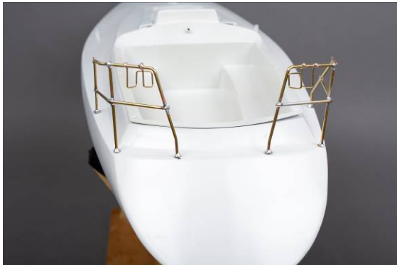
Abb. Heckkörbe mit Haltern für Rettungswesten
