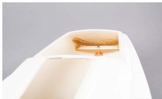
Vue: puits de gouvernail collé
