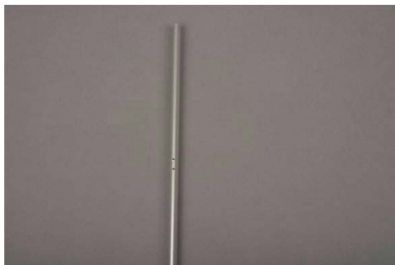
Abb. Bohrungen für Wantenbefestigung
