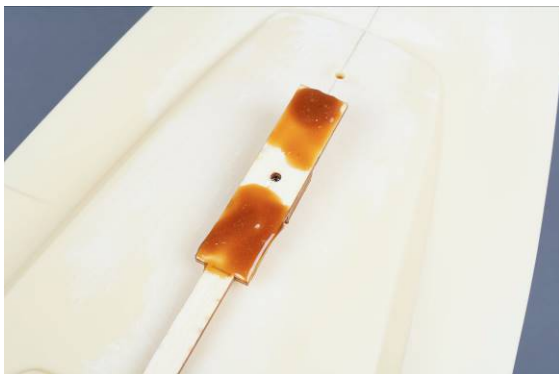
Abb. vorderes Verstärkungsblech mit Mutter M 3 und Augenschraube M 3
