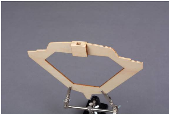
Abb. Hauptspant verklebt
